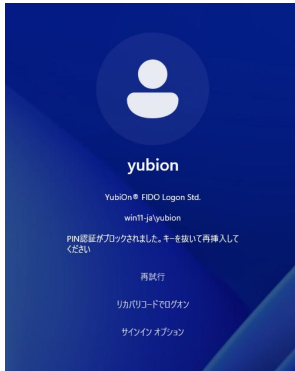
図：PIN 認証が一時的にブロックされた画面（抜き差しで復帰）
